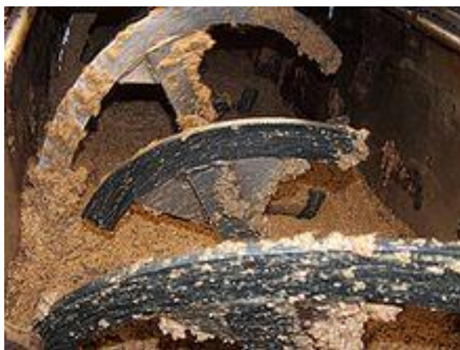
Pâte d'huile en mélange à l'intérieur d'un malaxeur
